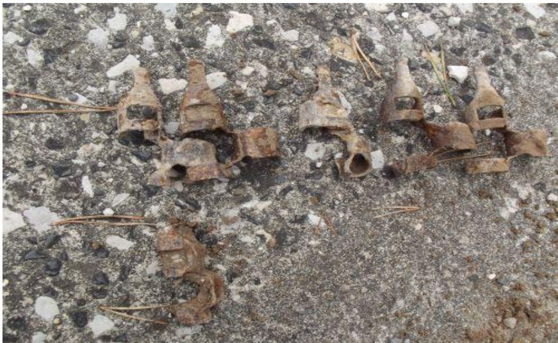
Zerfallglieder eines Munitionsgurtes für Kaliber .50 Munition für Panzer. Gefunden neben einer der betonierte Feuerstellung für Panzer auf der Range 6. Nach dem Verschluss zerfällt der Munitionsgurt in einzelne Zerfallglieder und bleibt liegen. Dies sind stumme Zeugen der einstigen Aktivitäten des Militärs auf dem Gelände.
